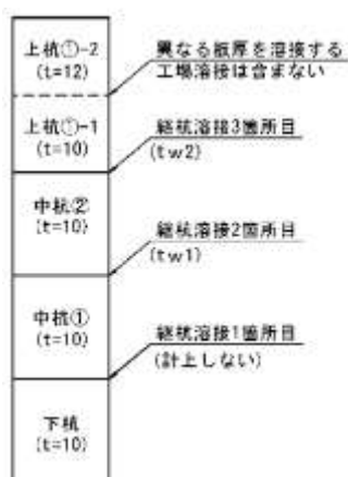
図 5-1 継杭溶接箇所 (参考図)
