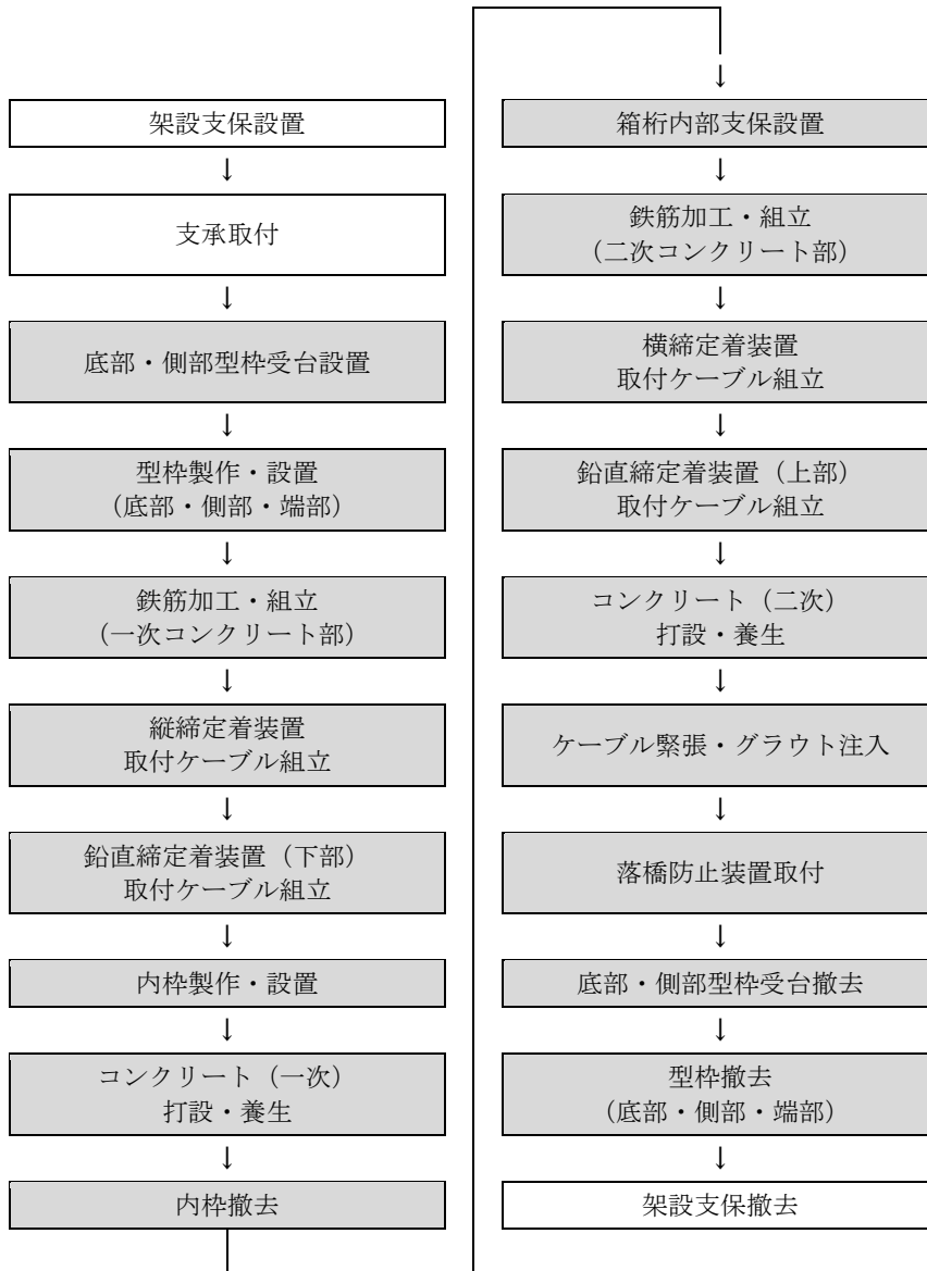
図 2-1 施工フロー
