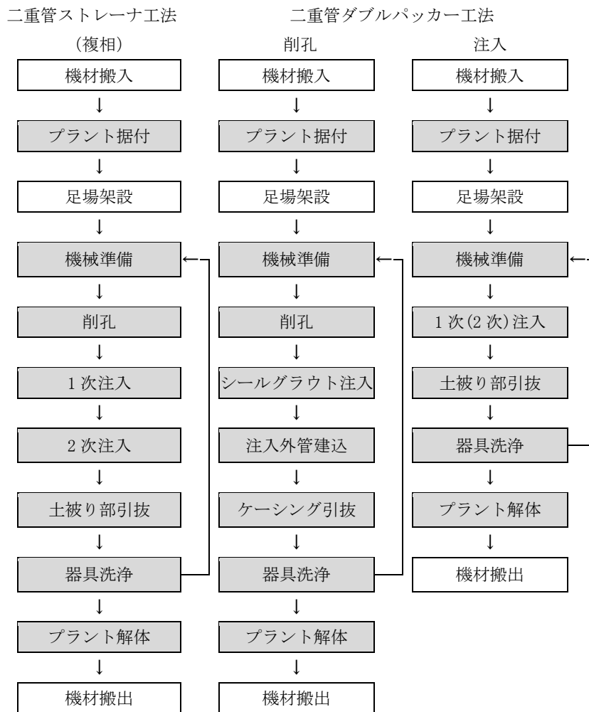
図 2.1 施工フロー図
