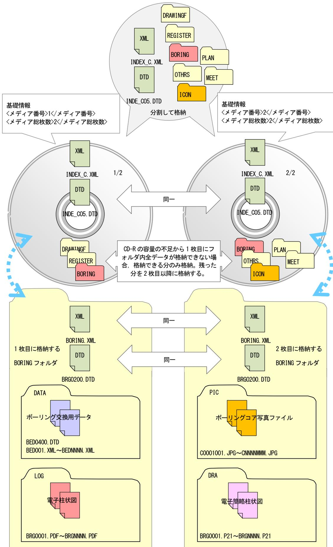
図 5-29 電子媒体が 2 枚になる場合の作成 (例) 【フォルダを分割する場合】
