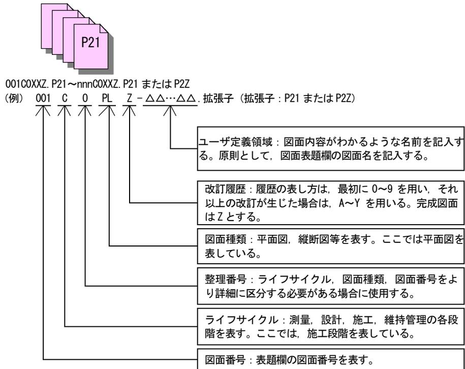
図 5-6 工事完成図ファイルの命名 (例)
